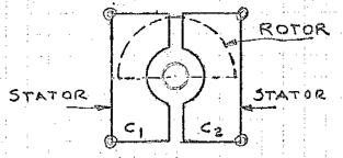
THE REVOLTAGE DIVISION DEPENDS UPON THE REACTANCE OF EACH SECTION OF THE CAPACITOR THE YALUE OF THE CAPACITANCE FOR RF VOLTAGE DIVISION DEPENDS UPON THE FREQUENCY, THE ATTEN. VATOR BEING VARIABLE, THE RF VOLTAGE TO THE LOAD CAN BE ADJUSTED TO MAY VALUE. ALARGE VALUE AT CLAND A SMAKE VALUE AT CZ, GIVES A LARGER VOLTAGE AT THE LOAD.
